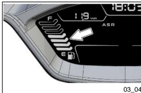
Der Benzinstand im Tank wird auf der linken Seite des Digitaldisplays angezeigt.
